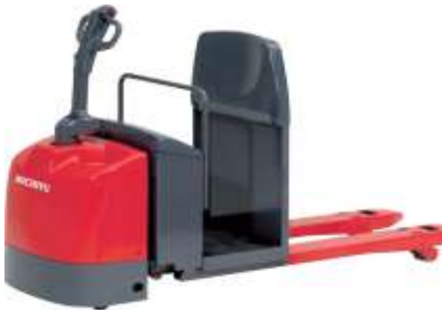
站驾货叉在后面的电动托盘车
